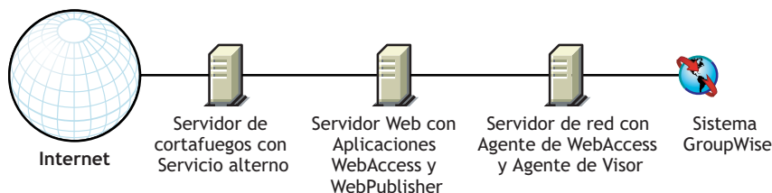
Figura 5-5 WebAccess instalado en un entorno que utiliza un servicio de apoderado (proxy)
