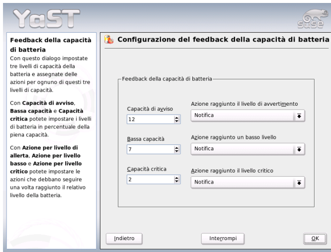
Figura 16.4: YaST-power management: stato di caricamento della batteria
