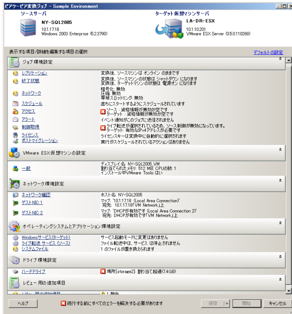
図 4-1 ピアツーピアのマイグレーションジョブのウィンドウ (詳細モードでのP2V)
